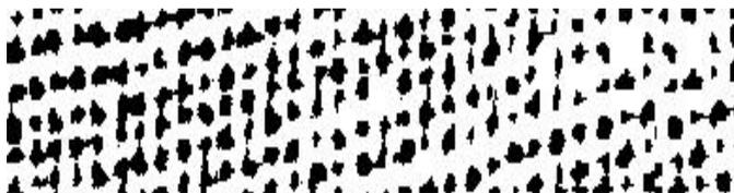
Рис. 3 Результат прямой бинаризации изображения контролируемой ткани
